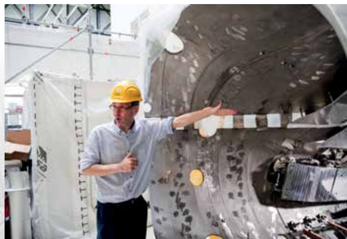
> Heißes Nichts: Kleiber erklärt das Innenleben eines Stellarators, bei dem das hochgradig verdünnte Plasma auf 150 Millionen Grad erhitzt wird.
